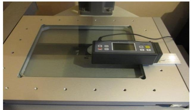
Fig. 3. Needle profile meter SRT-6200
